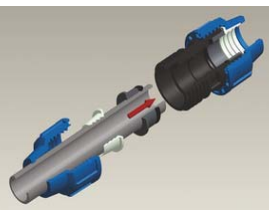
2. Cev s prstanastim obročem, varovalnim obročem in o-ring tesnilom vstavite do končnega nastavka v fittingu. Preverite, da sta o-ring tesnilo in varovalni obroč na pravem mestu.
